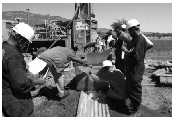
井戸掘削後の揚水試験訓練の様子
